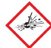
PELIGRO DE EXPLOSIVOS
